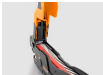
Une fois les bandes d'embouts de fils insérées dans le magasin, le travail peut commencer immédiatement.
