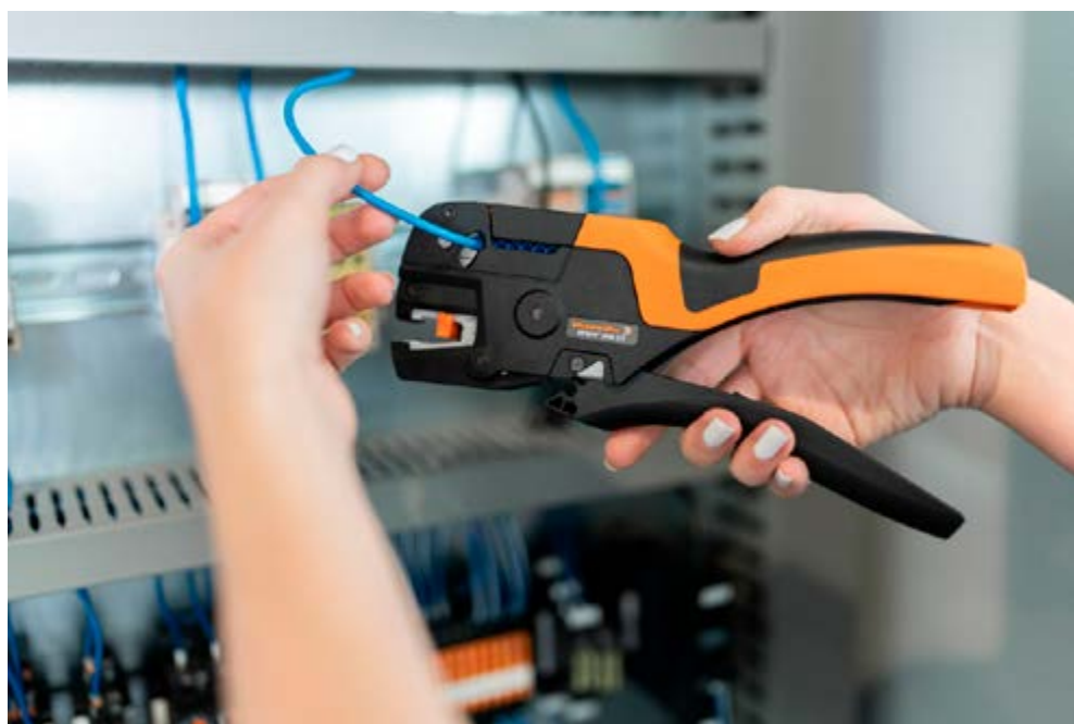
Grâce à l'articulation universelle, la probabilité d'erreurs avec la stripax® plus est nettement réduite.
